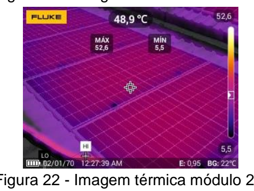
Figura 22 - Imagem térmica módulo 20.
