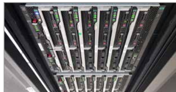
Chassis com lâminas do tipo blade
